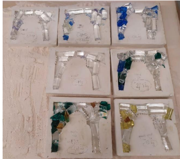
obr. 34 Sklo poskládané ve formách, před utavením, foto z archivu autora, 2021
