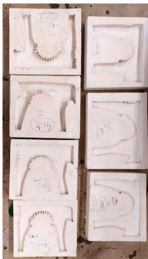
obr. 32 Formy uschnuté a vyfoukané, foto z archivu autora, 2021
