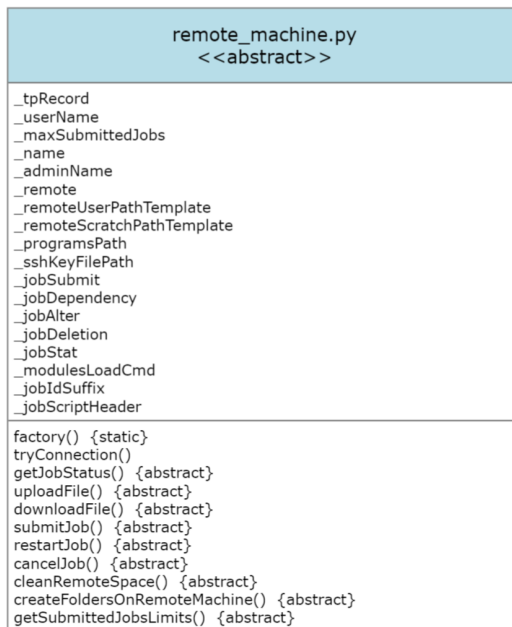
Obr. 5.4: Skrátená verzia UML reprezentácie remote_machine.py
