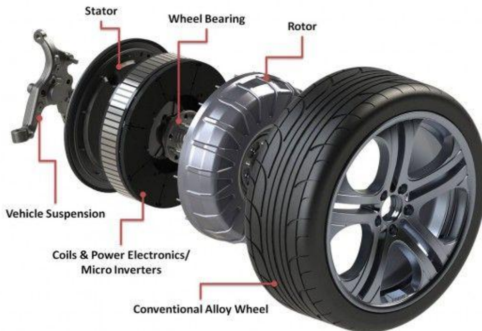
Obr.7 Elektromotor v náboji kola [10]
