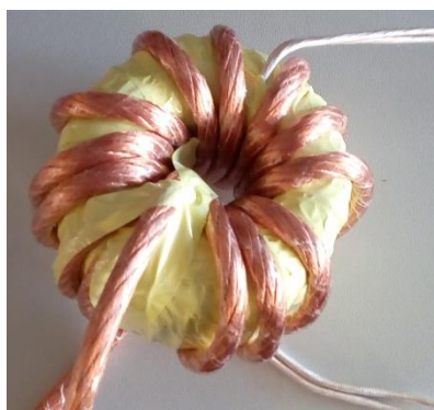
Obrázek 18: Fotografie navinutého výkonového transformátoru
