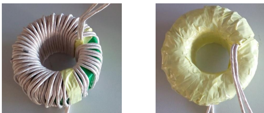
Obrázek 17: Fotografie navinutého primárního vinutí
