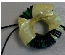
Obrázek 20: Fotografie měřícího transformátoru proudu
