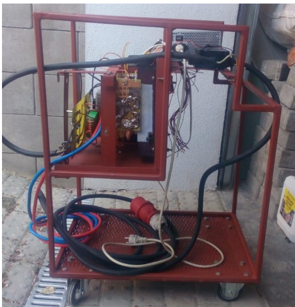
Obrázek 23: Fotografie celkové konstrukce svářečky
