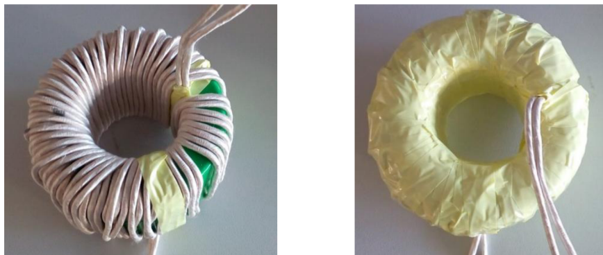
Obrázek 17: Fotografie navinutého primárního vinutí
