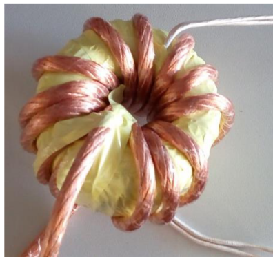
Obrázek 18: Fotografie navinutého výkonového transformátoru
