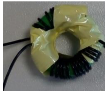
Obrázek 20: Fotografie měřícího transformátoru proudu
