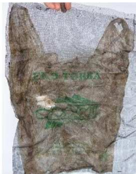
Obrázek č. 19: Vzorek č. 4 před vložením do kompostu a následně po vytažení z něj [37]
