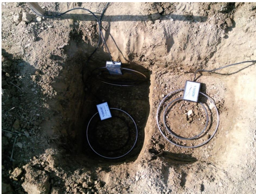
Obr. 2.: Umístění snímačů pro měření objemové vlhkosti půdy v Hořejších Kunčicích (zdroj – autor 2014).
