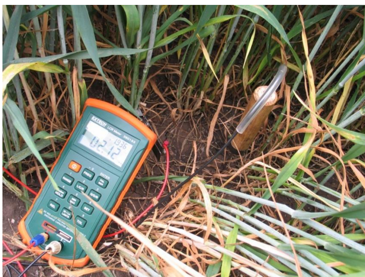
Obr. 3.: Měření elektrické kapacity kořenového systému (zdroj – T. Středa 2014).
