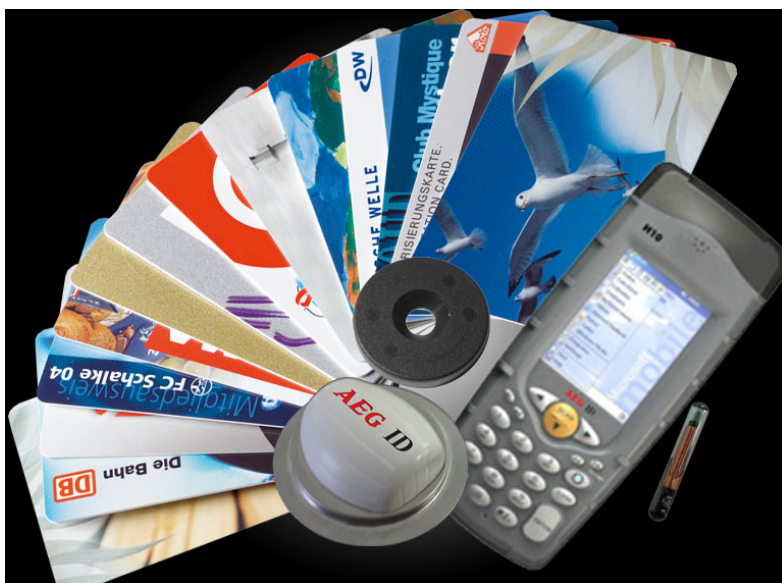
Obrázek A1: Vzorčky karet, čtecí zařízení a soudkový transpondér určený k identifikaci vinných sudů
