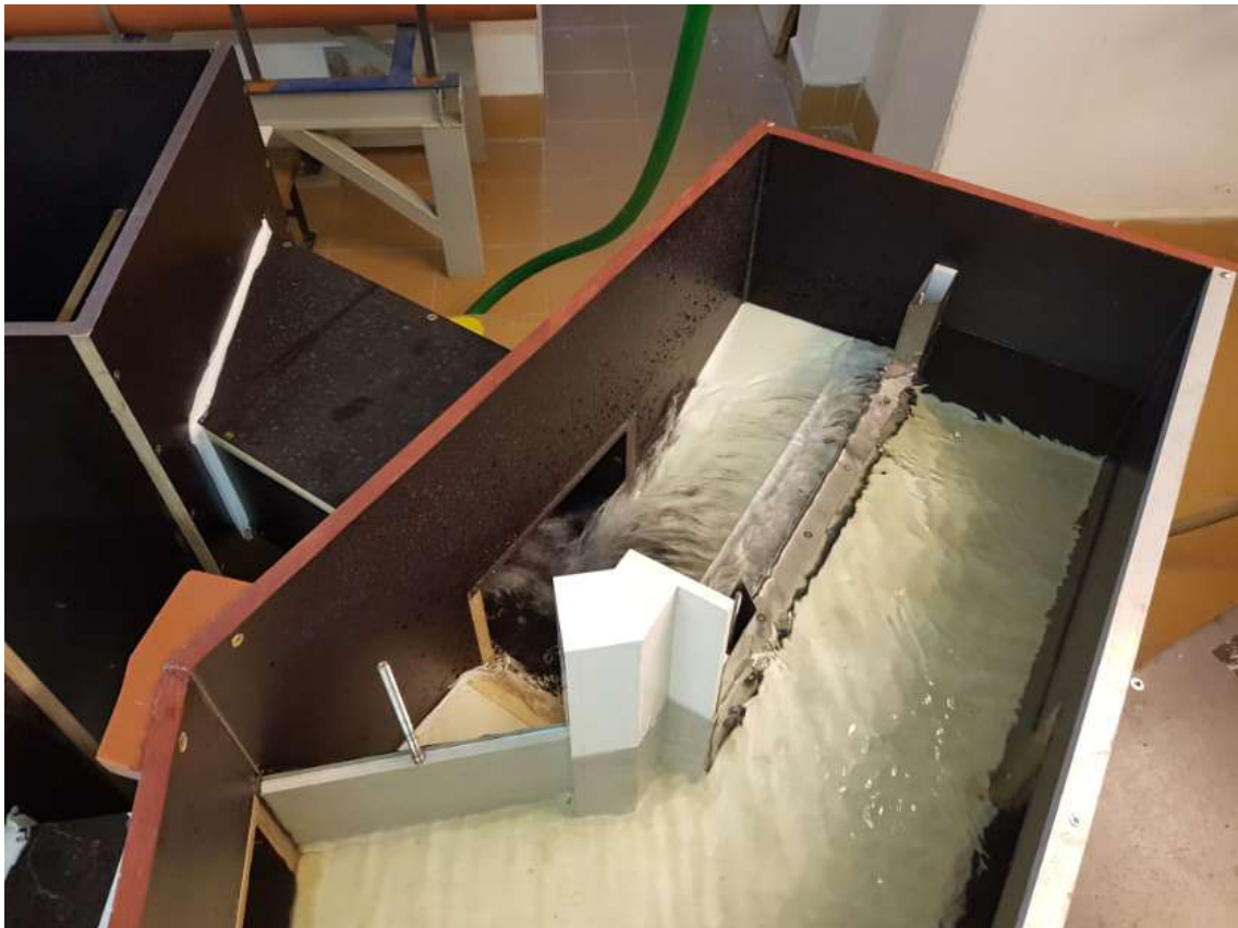
Obr. 27) Měření celkové Q/h charakteristiky SK ČOV při hodnotě Z = -0,208 m
