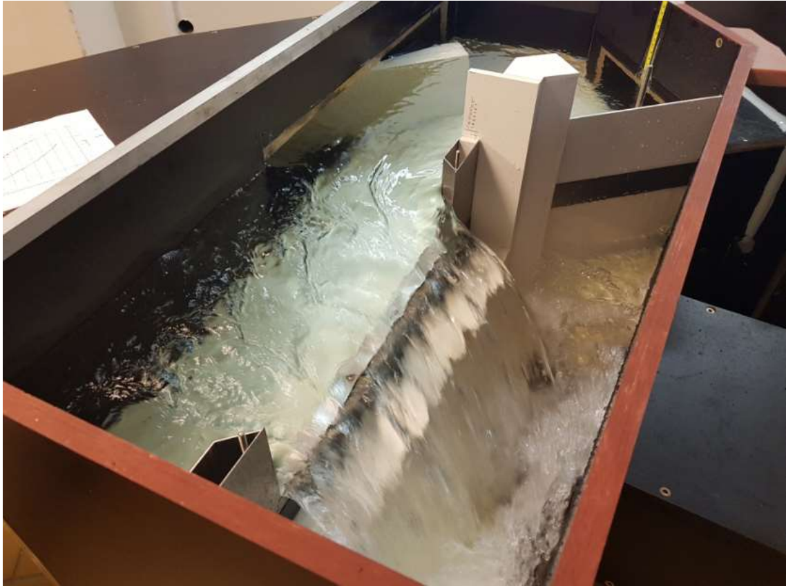
Obr. 26) Měření přepadu pouze přes tabulový uzávěr
