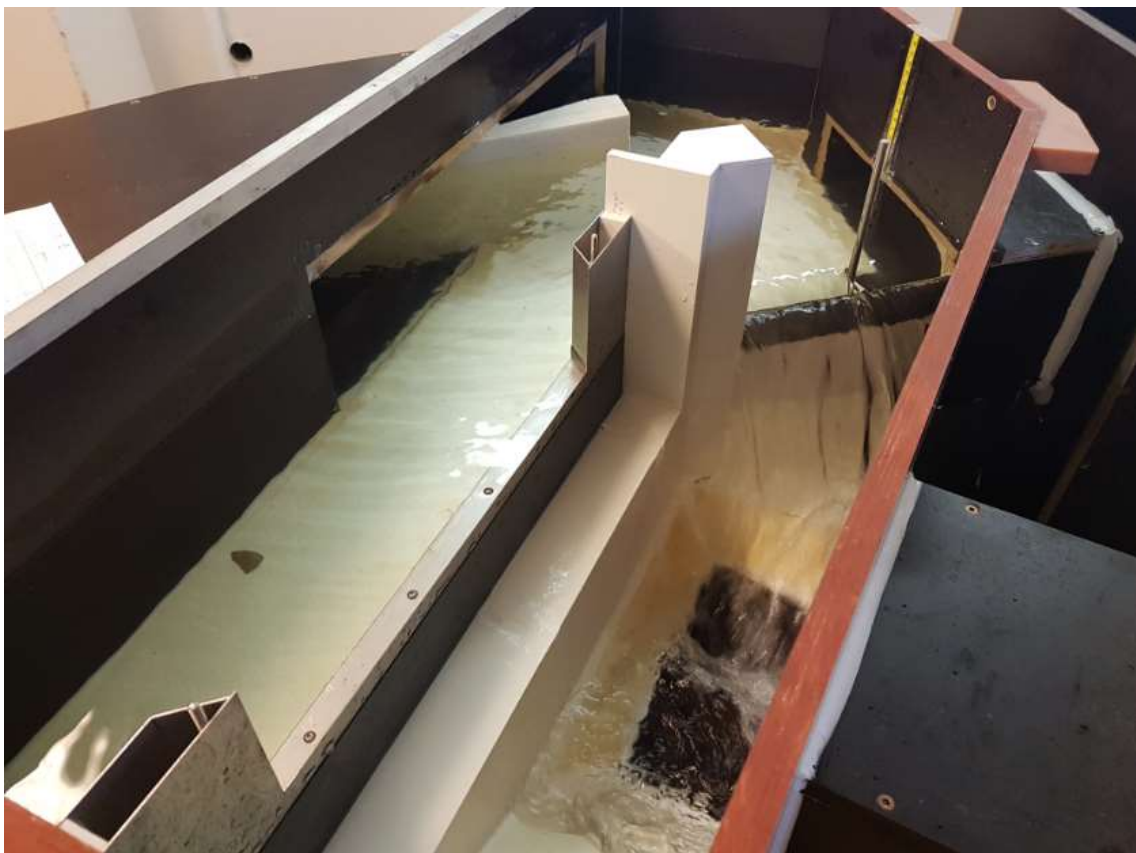
Obr. 28) Měření celkové Q/h charakteristiky SK ČOV při hodnotě Z = +0,244 m
