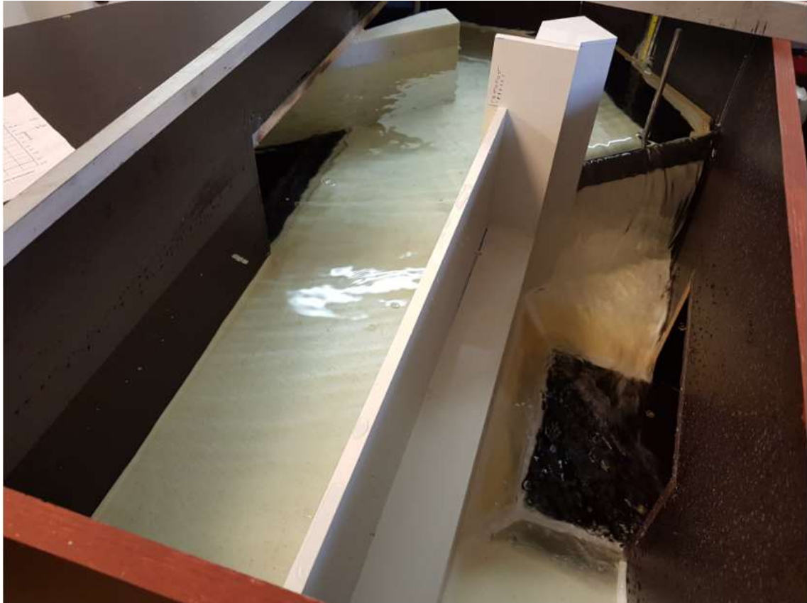
Obr. 25) Měření s podmínkou přepadu pouze přes pevné stavidlo
