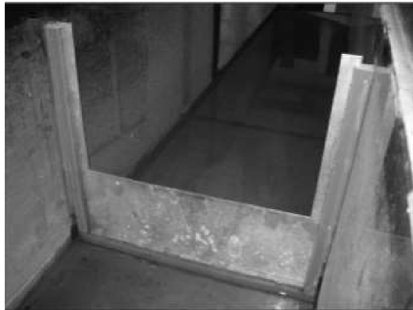
Obr. 4) Přeliv s pravouhlejším výřezem s bočním zúžením [4]
