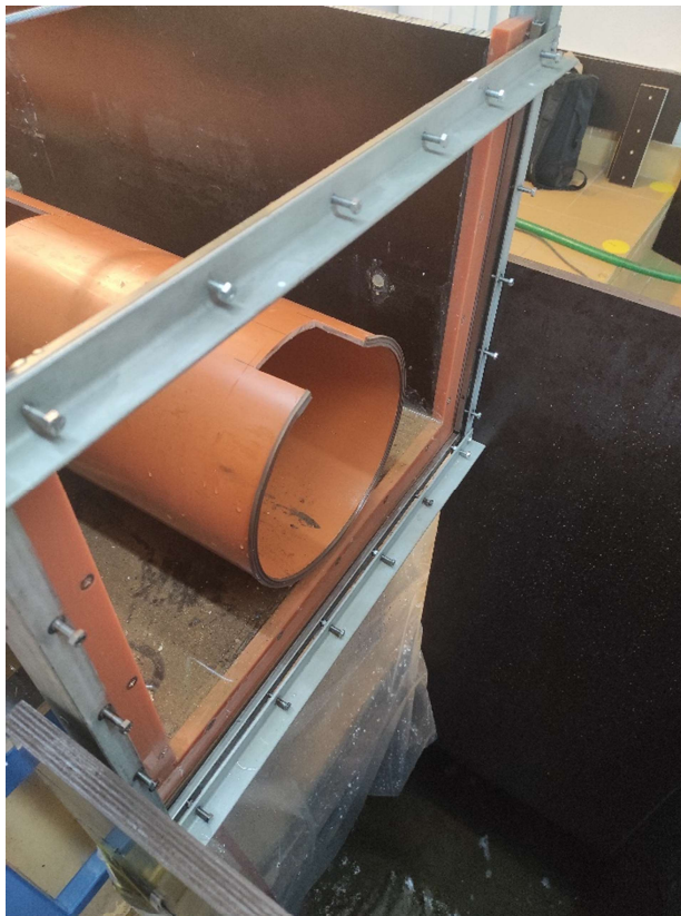
Obrázek 11 Rám pro přeliv na výtoku ze žlabu
