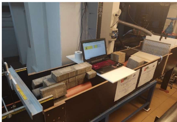
Obrázek 10 Střední část žlabu s potrubím
