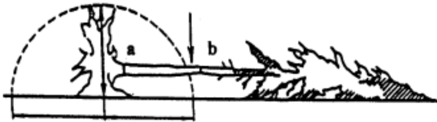
Obr. č. 2 - Bezpečné odříznutí kmene vývratu
