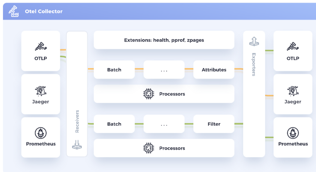
Obrázek 2.5: Ukázka architektury kolektoru 11
