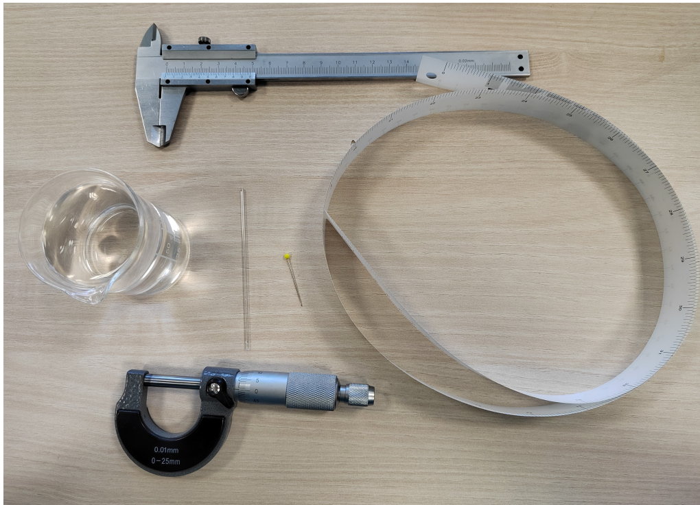
Obrázek 3.2: Pomůcky k měření metodou kapilární elevace [Foto autora]
