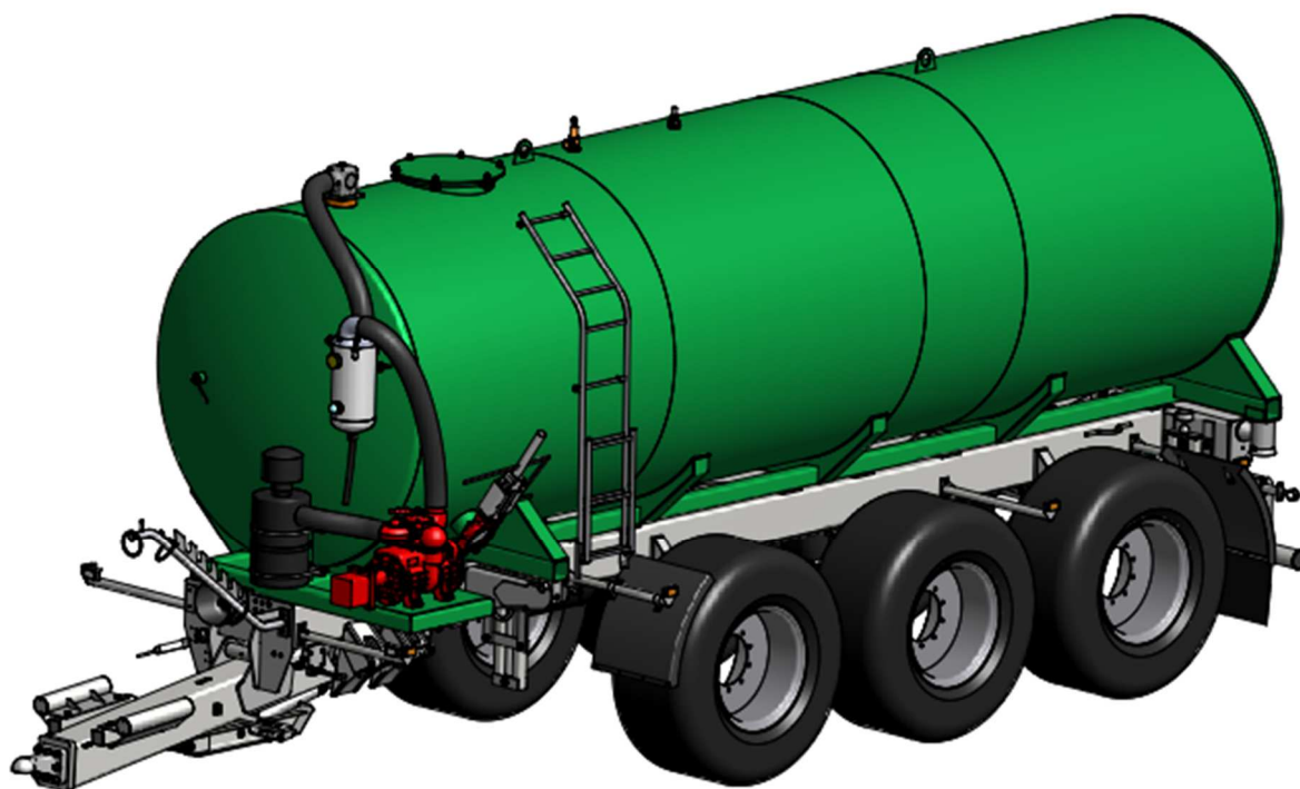
Obr. 29 Konstrukce cisternové nástavby spolu s nosičem nástaveb MEGA 33
