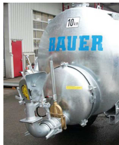
Obr. 18 Zadní otvor s rozstřikovací koncovkou [18]
