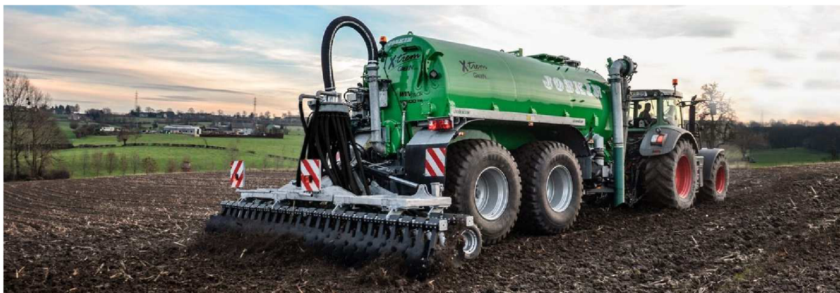
Obr. 4 Fekální cisterna Joskin s diskovým aplikátorem [12]
