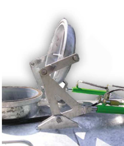
Obr. 16 Hydraulicky uzavíratelný vrchní otvor [18]
