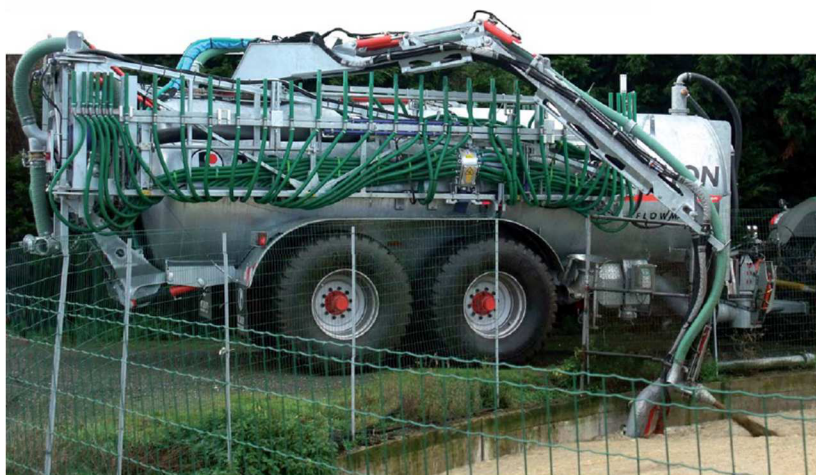
Obr. 23 Fekální cisterna Pichon s ponorným čerpadlem [15]
