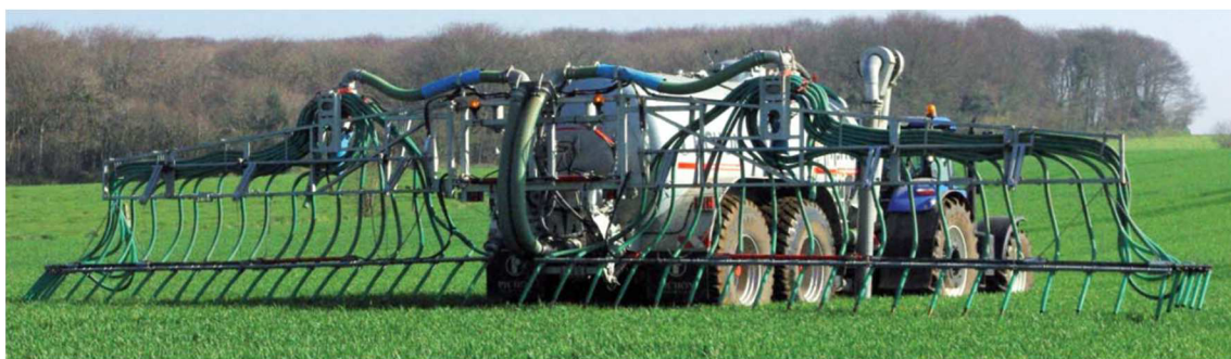
Obr. 3 Fekální cisterna firmy Pichon vybavená hadicovým aplikátorem [15]
