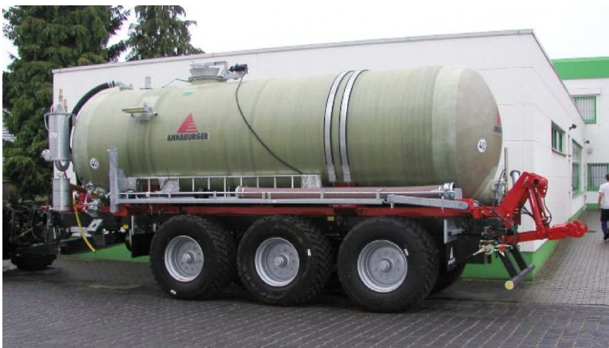
Obr. 26 Výměnný systém HTS 29.79 s cisternovou nástavbou [22]
