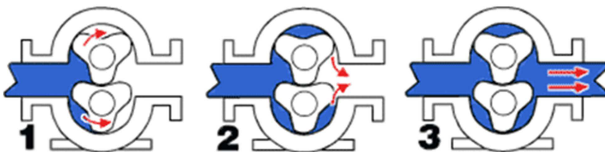
Obr. 11 Čerpadlo s rotačními písty [17]
