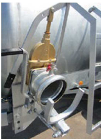
Obr. 17 Stranový otvor s ventilem a spojkou Perrot [18]
