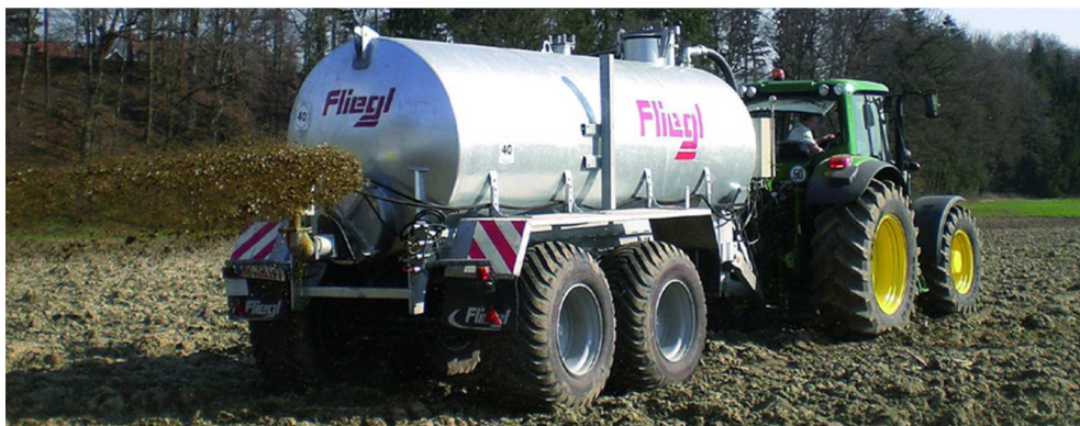
Obr. 2 Fekální cisterna firmy Fliegl vybavená rozstříkovací koncovkou [14]
