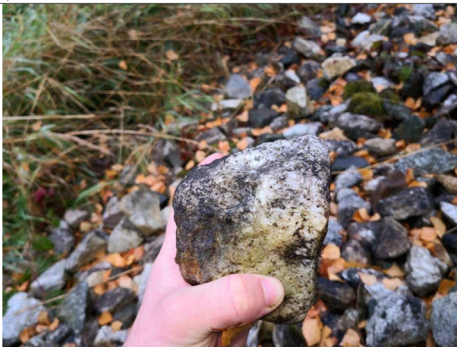
Obr.31 Kamenný pohoz stávajícího nouzového koryta z valounů
