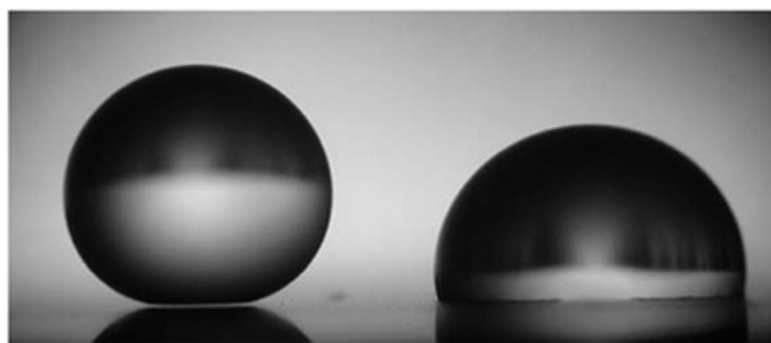
Obrázek 6- Kapka ve stavu Cassie- Baxter vlevo přejde do stavu Wenzel vpravo [12]
