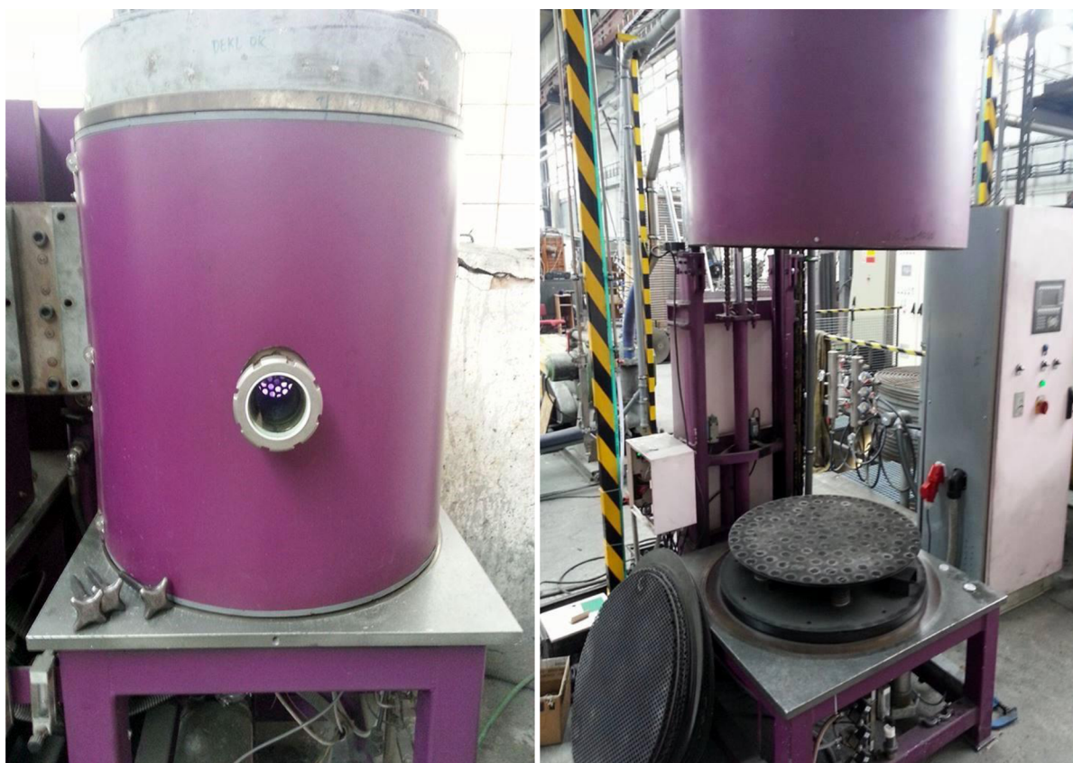
Obr. 2.3 Nitridační pec v provozu (vlevo) a otevřená (vpravo).
