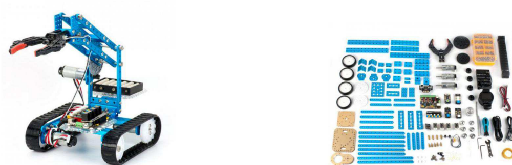
Obr. 31 Robot sestavený z prvků Makeblock (18)
