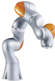
Obr. 5 Nestavebnicová konstrukce kolaborativního robota (11)
