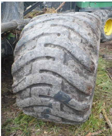
Obr. 4 - Nízkotlaké pneumatiky forwarderu John Deere 1110 o šířce 710
