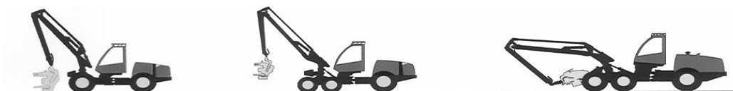
Obr.6 -Rozdělení harvestorů dle velikosti a) malý b) stření c) velký (Ulrich 2003)
