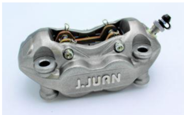
Obrázek 46: Přední brzdový třmen J.JUAN s roztečí 100 mm [8]
