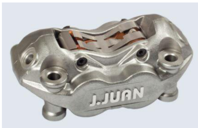
Obrázek 47: Přední brzdový třmen J.JUAN s roztečí 108 mm [9]
