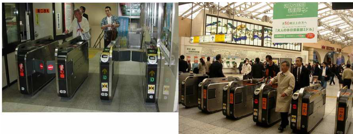
Obr. 11 Vstupní brány se zabudovanými piezoměniči.
