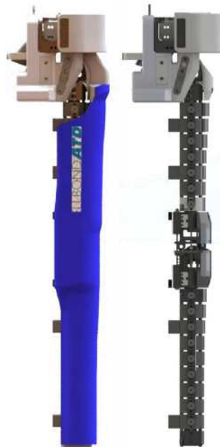
Obr. 46 Model impaktoru Flex PLI s přidanou pohyblivou hmotou na horním konci (31)
