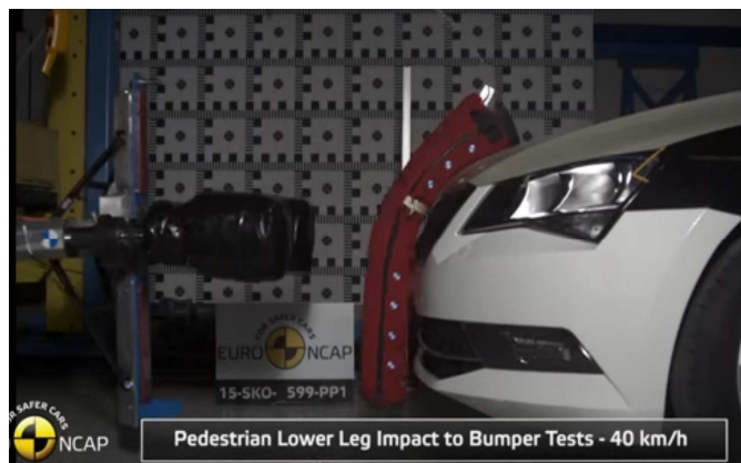
Obr. 116 Čas 25 ms, stehenní kost je nejvíce ohnutá; stejně tak koleno; holeň se vlivem působení kolene a odrazem začíná opět ohýbat, odpoutává se od nárazníku
