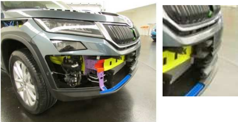
Obr. 7 Škoda Kodiaq s naznačenými deformačními prvky. Fialově, červeně a žlutě označena výztuha nárazníku se svislými nosníky a modrou podpůrnou rovinou kvůli zkouškám ochrany chodců. Mezi žlutou přední částí výztuhy a plastovým vnějším krytem nárazníku je možné vidět pěnový padding (10)
