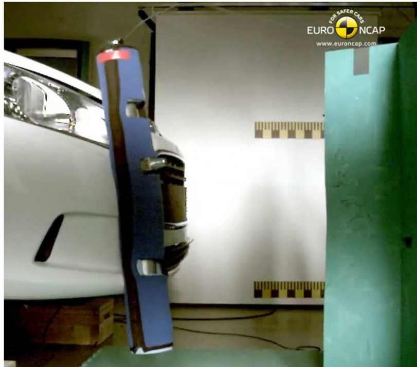
Obr. 38 Příklad testu impaktorem staršího impaktoru nohy LLEG (TRL) (23)
