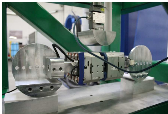
Obr. 66 Kolenní část impaktoru připravená ke statické certifikaci
