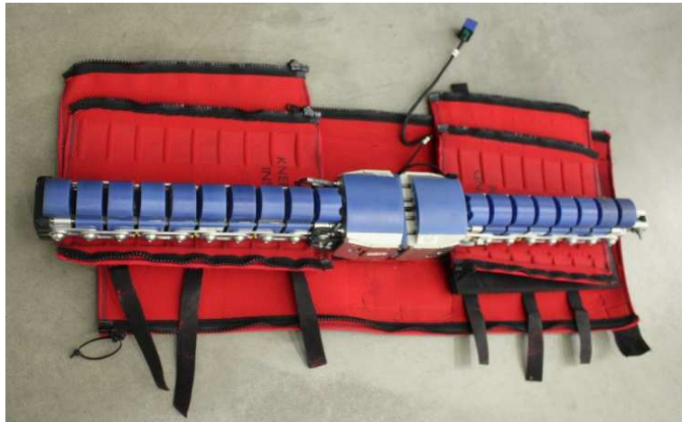
Obr. 59 Impaktor Flex PLI s odepnutými pryžovými a neoprenovými částmi
