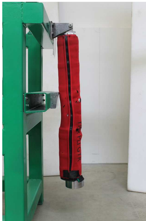
Obr. 73 Impaktor při pendulum certifikaci, zavěšený za holeň, se závažím na stehenní části
