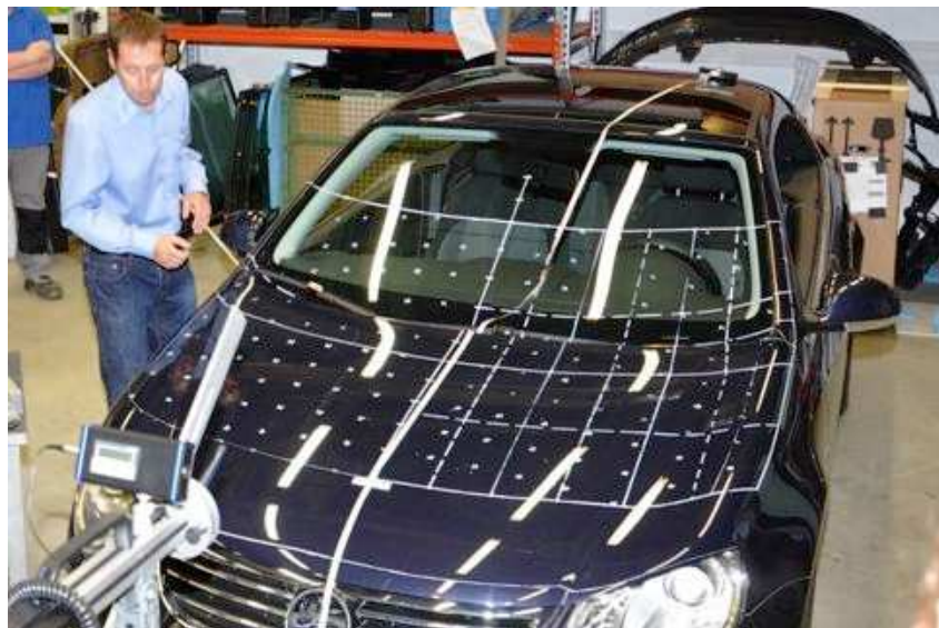
Obr. 25 Rozměřování zón paralelogramem s lineárním vedením Merlin v laboratoři BGS v bast (Bundesanstalt für Straßenwesen, Spolkový dálniční úřad) v Německu. Na kapotě a skle je vidět porovnání ENCAP rozměření vpravo starším způsobem a „gridem“ s rozestupem 100 mm po celé kapotě (15)
