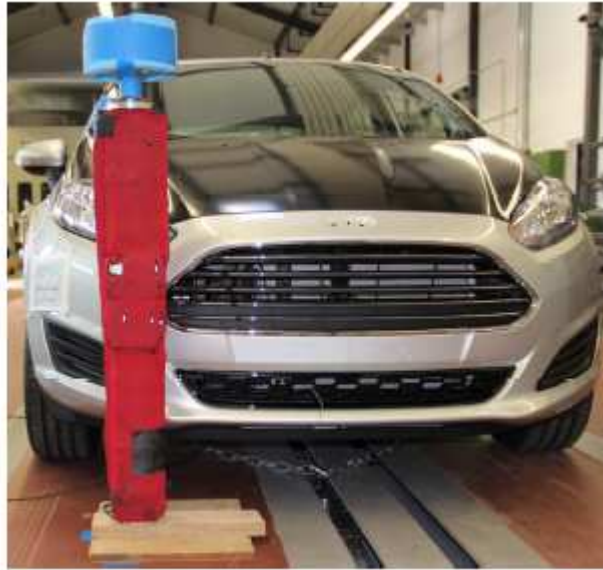
Obr. 45 Model impaktoru Flex PLI s přidanou hmotou na horním konci v porovnání s vozidlem (30)
