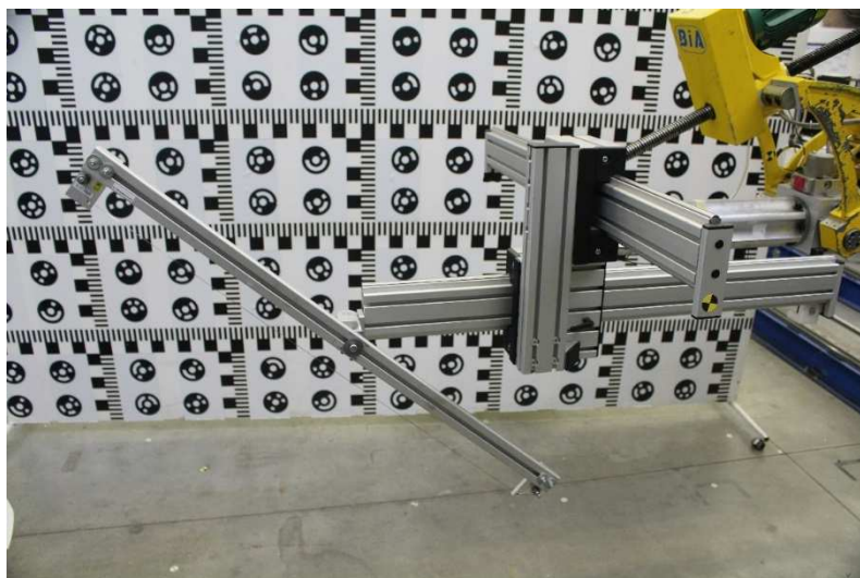
Obr. 11 Rozměřovací kříž pro rozměřování zkušebních zón připevněný na zkušebním stroji, s břitem v podobě ocelové struny
