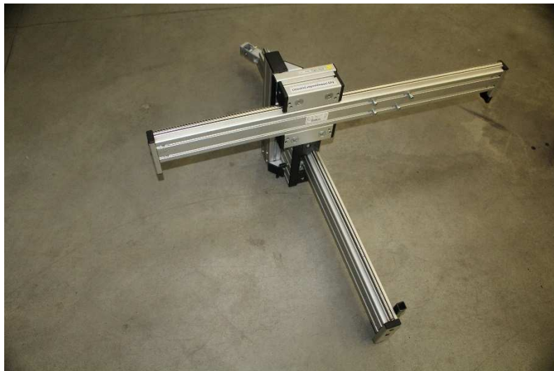
Obr. 10 Rozměřovací kříž pro rozměrování zkušebních zón
