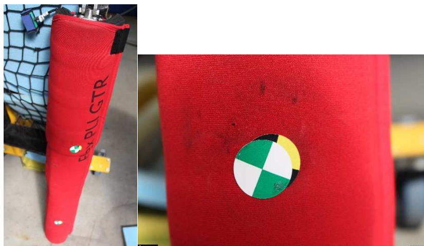
Obr. 93 Terčůky na impaktoru použité pro zjištění přesnosti zásahu
