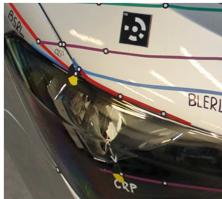
Obr. 18 Vztažný bod kapoty (CRP) rozměřen na reálném vzorku, na spojnici BLERL (modrá) a BSRL (červená). Níže přenesen na WAD 775 (fialová)
