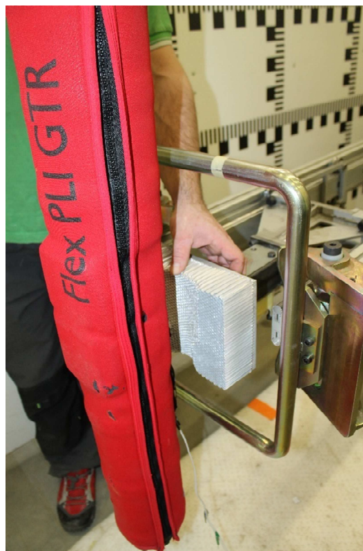
Obr. 79 Naznačení dopadu nárazového vozíku s voštinou do visícího impaktoru. Na vedení vozíku jsou dorazy s hydraulickými tlumiči nárazu, které o nárazu do impaktoru zastaví vozík. K ovlivnění certifikace nedojde.
