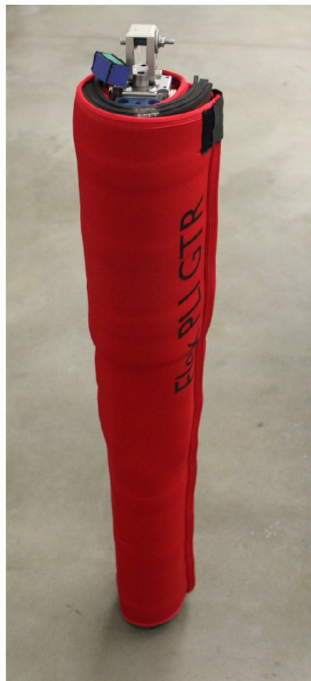
Obr. 58 Impaktor Flex PLI, verze bez kabelů s „onboard“ záznamem dat
