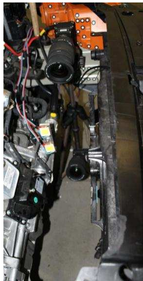
Obr. 99 Kamery použité pro sledování pohybu světlometu, měření 3D fotogrammetrií
