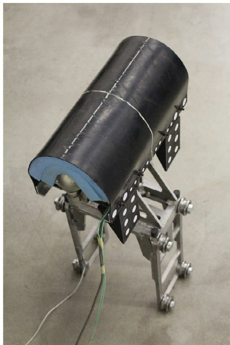
Obr. 32 Impaktor ULEG s rolnami pro vedení impaktoru. Tělo impaktoru se skládá z ocelové „kosti“, modré pěnové „svaloviny“ a černé pryžové „kůže“
