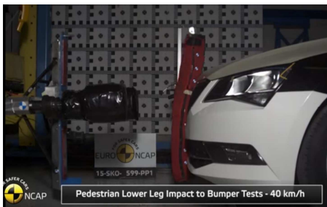
Obr. 107 Čas 10 ms po dopadu, stehenní kost se ohýbá dozadu; koleno je téměř rovné, nejnižší části holeně jsou ohýbány přes spodní část nárazníku
