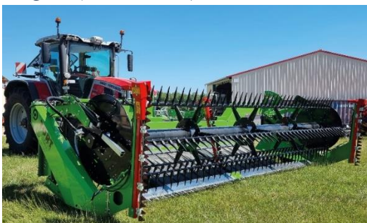
Obrázek 12: Traktorový řádkovací adaptér (Kužel, 2023)
