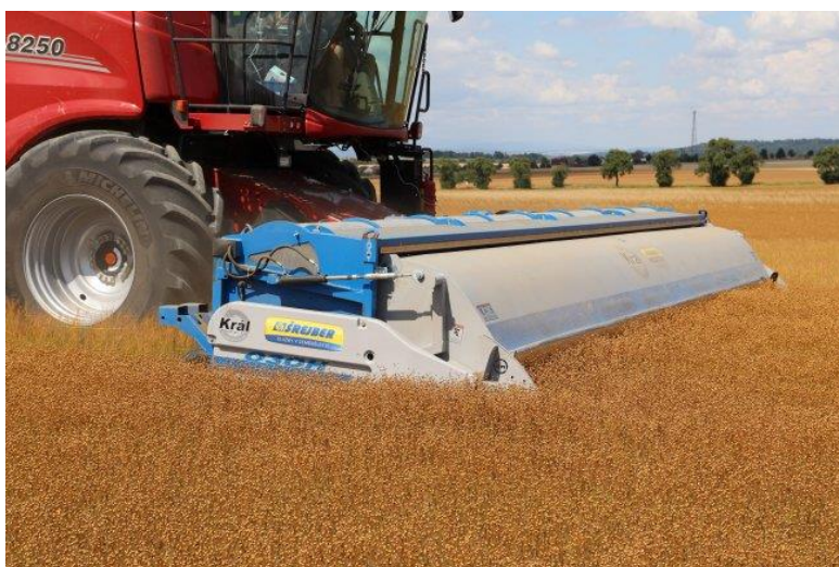
Obrázek 6: Vyčesávací adaptér Ozon (Jehlička, 2022)
