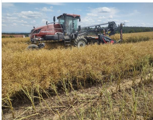
Obrázek 19: Řádkovač při sklizni řepky
