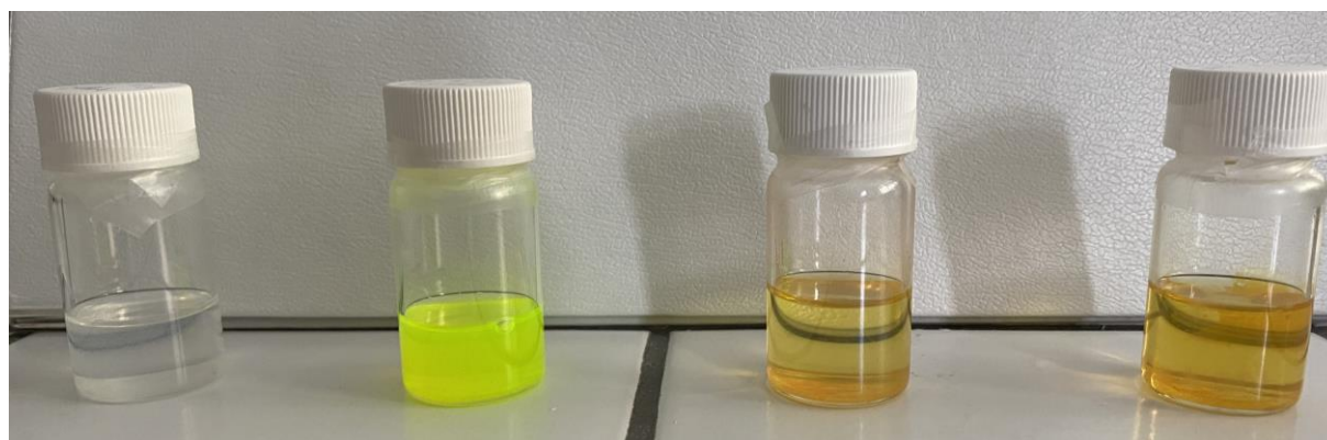
Obrázek č. 6: Připravené roztoky perovskitových nanočástic po centrifugaci. Zleva doprava: MAPbCl 3 v toluenu, MAPbBr 3 v toluenu, Cs 3 Bi 2 I 9 v toluenu, Cs 3 Bi 2 I 9 v ethanolu.
