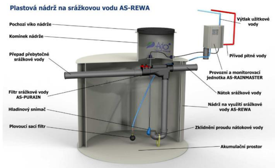
Obrázek 34: Plastová nádrž na srážkovou vodu AS-REWA (ASIO ©2021).
