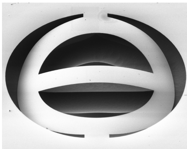
Obrázek 4.19 Detail vyrobeného Guckelova prstence se středním poloměrem 250 \mu\text{m}
