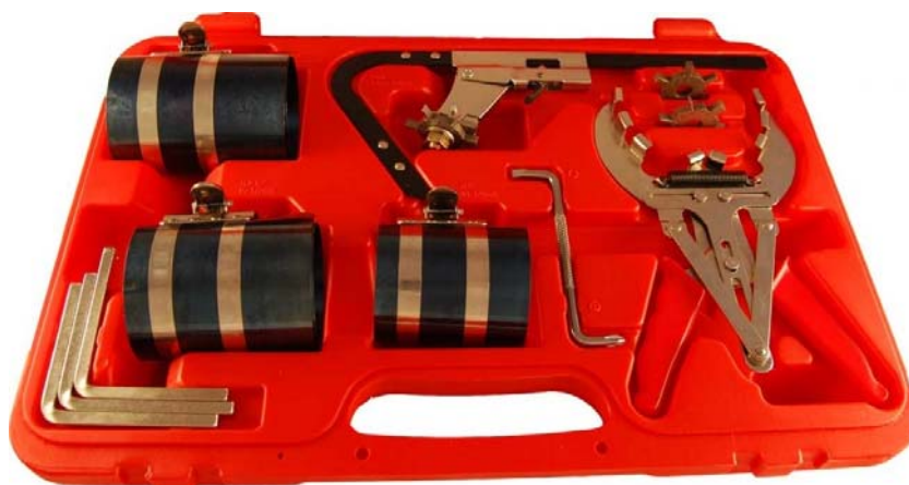
Obr. 43 Sada nástrojů pro montáž pístních kroužků [13]
