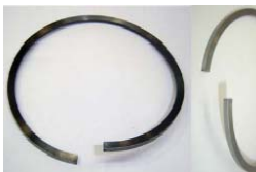
Obr. 42 Vyhnutí konců pístního kroužku [6]
