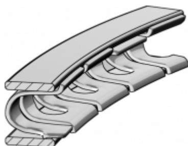
Obr. 12 Tvar příčného průřezu stíracího pístního kroužku skládaného ze tří částí [15]
