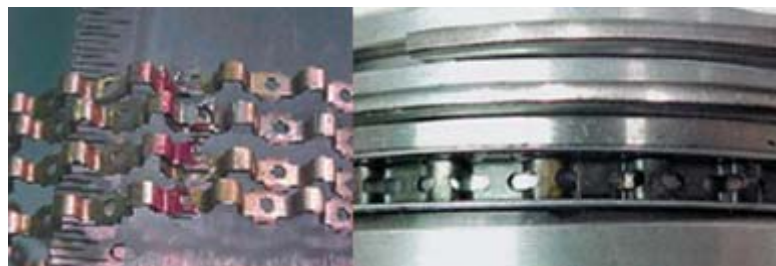
Obr. 38 Překrytí konce expanderu [6]
