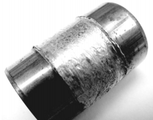
Obr. 23 Adhezní opotřebení pístního čepu [14]
