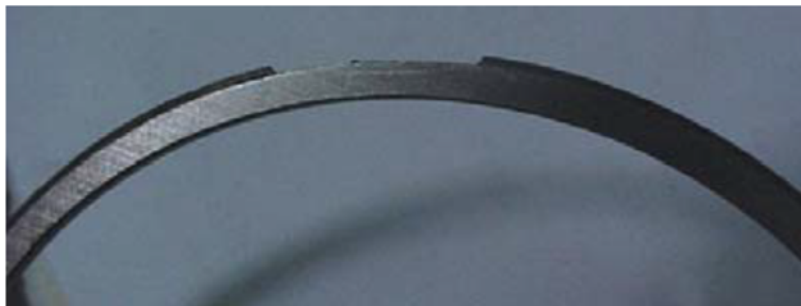
Obr. 41 Odštípnutí kontaktní plochy [6]
