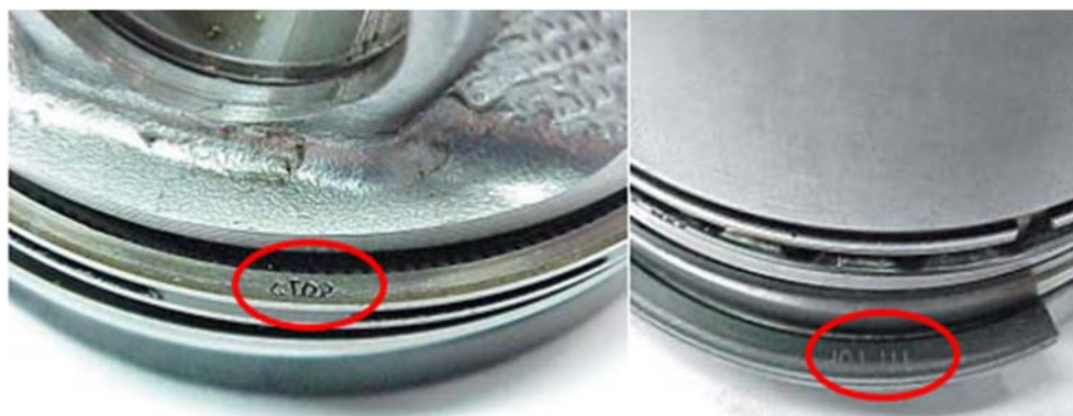
Obr. 37 Obrácený pístní kroužek na pístu [6]
