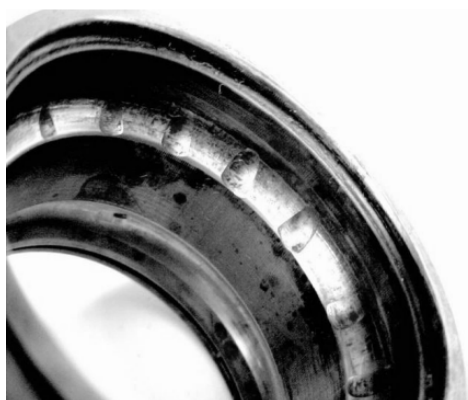
Obr. 28 Vibrační opotřebení valivého ložiska [14]
