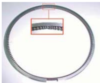
Obr. 39 Překrytí vynutí pružiny [6]
