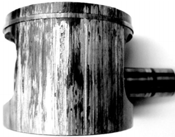
Obr. 25 Abrazivní opotřebení pístu spalovacího motoru [14]
