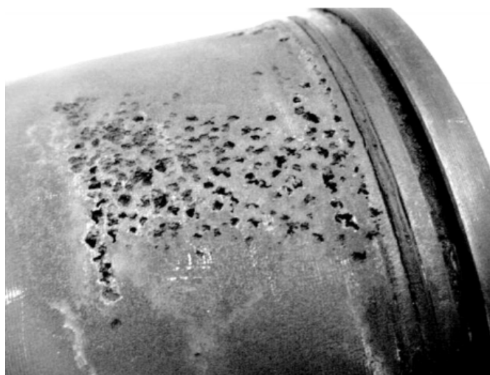
Obr. 30 Kavitační opotřebení pláště pistu spalovacího motoru [14]
