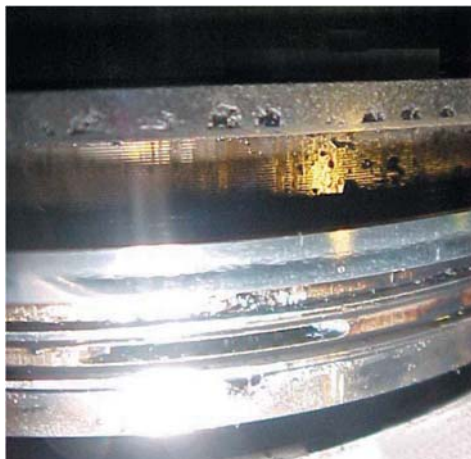
Obr. 48 Odlupování povlaku z pístních kroužků [6]
