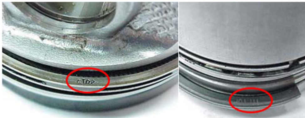
Obr. 37 Obrácený pístní kroužek na pístu [6]
