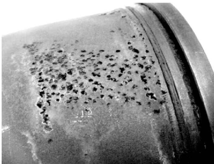
Obr. 30 Kavitační opotřebení pláště pistu spalovacího motoru [14]
