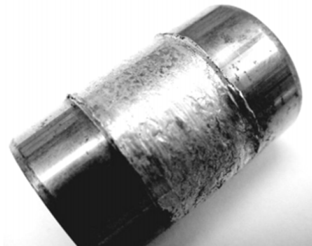
Obr. 23 Adhezní opotřebení pístního čepu [14]
