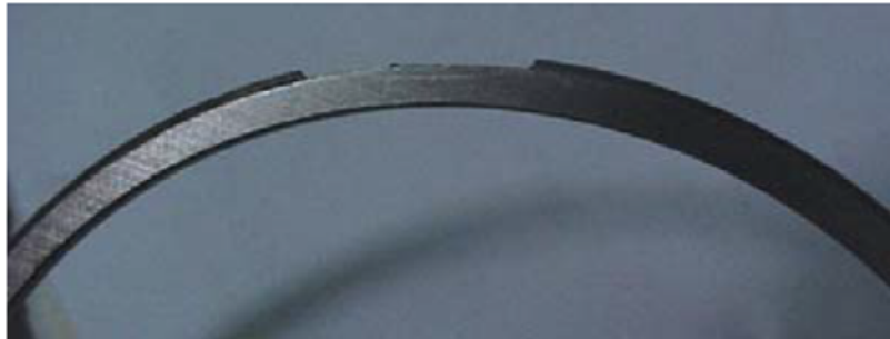
Obr. 41 Odštipnutí kontaktní plochy [6]
