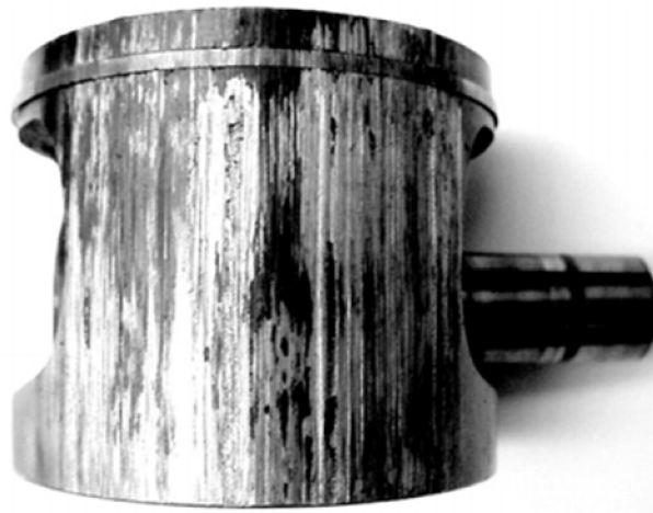
Obr. 25 Abrazivní opotřebení pístu spalovacího motoru [14]
