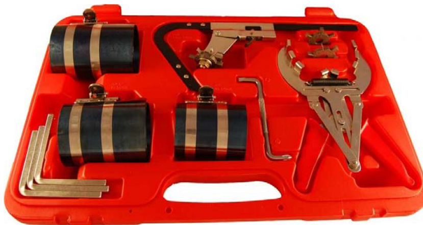
Obr. 43 Sada nástrojů pro montáž pístních kroužků [13]
