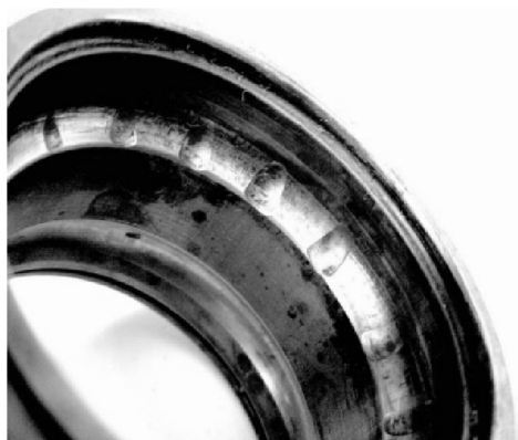
Obr. 28 Vibrační opotřebení valivého ložiska [14]
