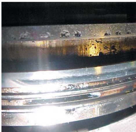
Obr. 48 Odlupování povlaku z pístních kroužků [6]
