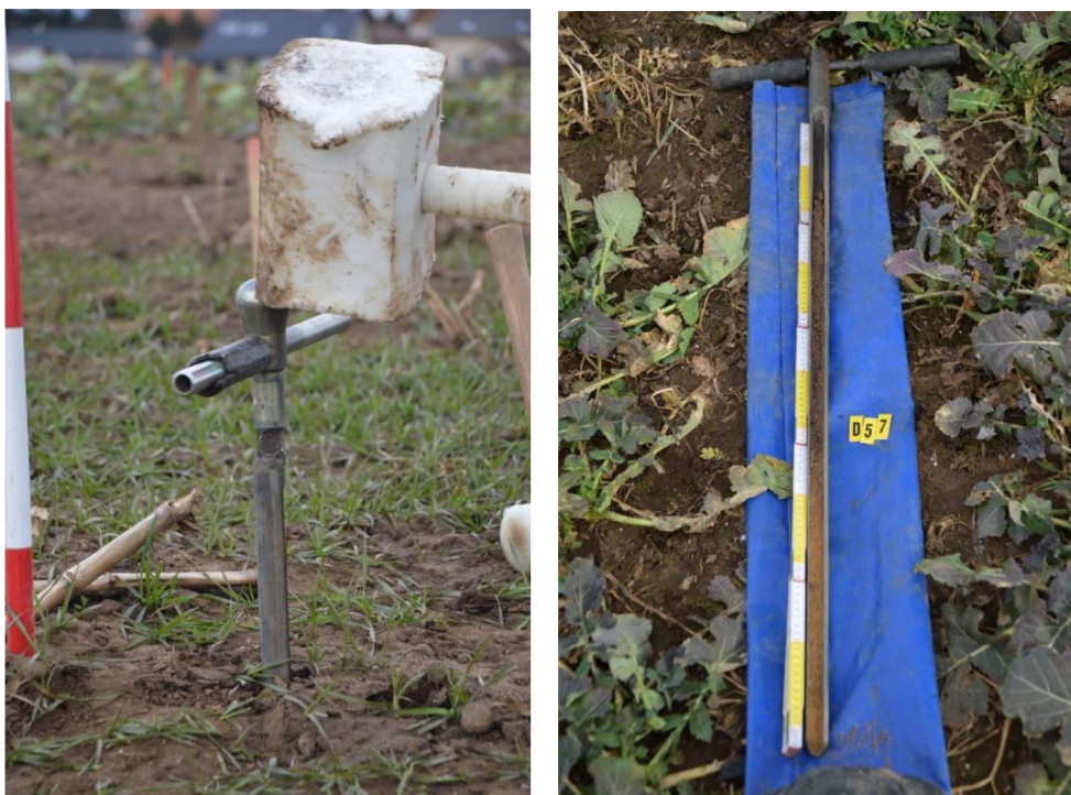
Obrázek 6: Odebírání vzorků půdní sondou (kontrolní odběr - mimo mohyly)
