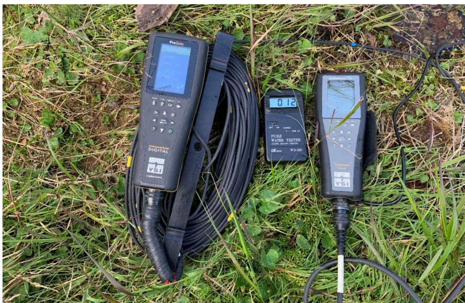
Obrázek 13: Multiparametrické YSI PRO sondy a sonda na měření vodivosti (foto: Jan Hůda).
