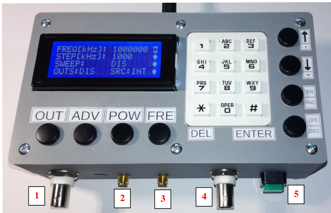
Obrázek 23: Realizovaný generátor uzavřený v krabičce (1 – vstup ext., 2 – OUT 2, 3 – OUT 1, 4 – logický výstup, 5 – spínač)
