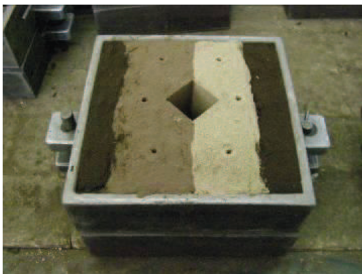
Obr. 2.22 Forma na licím poli připravená k odlití
