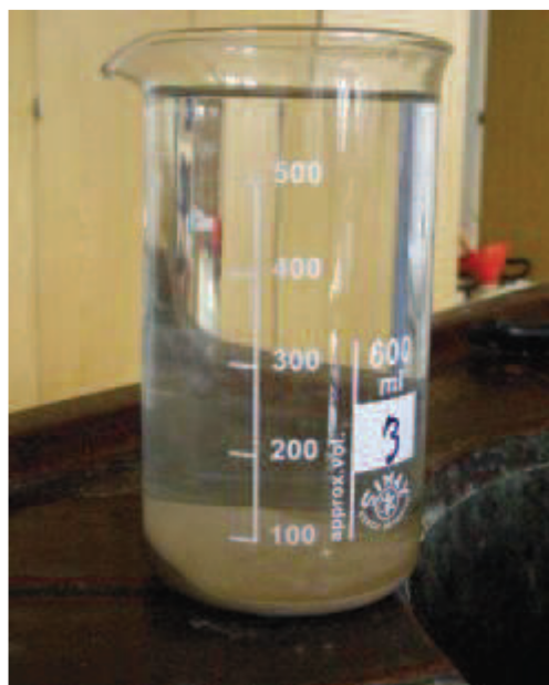
Obr. 2.6 Čistý sloupec vody nad ostřivem před posledním stažením
