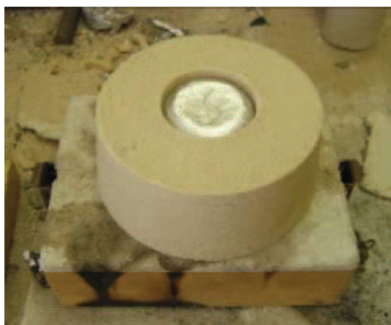
Obr. 2.18 Forma s nalitým kovem
