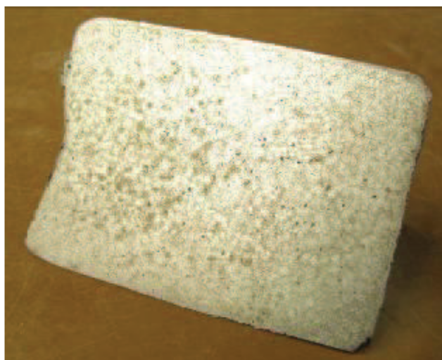
Obr. 2.28 Rozřezaný, vyleštěný a naleptaný vzorek
