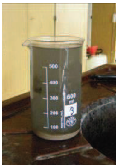
Obr. 2.5 Sloupec vody nad ostřivem před prvním stažením násoskou
