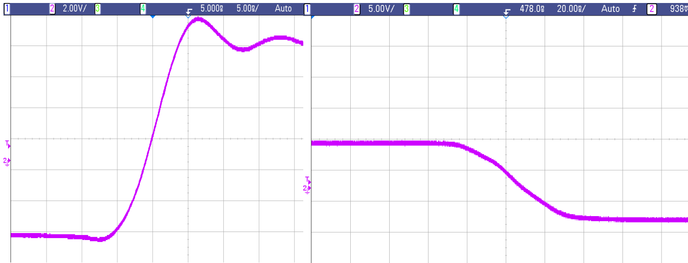
Obr. 17 Porovnání náběžné hrany při frekvenci 800kHz a střídě 0,35, vlevo nezatížený výstup budiče, vpravo připojena zátěž 220pF
