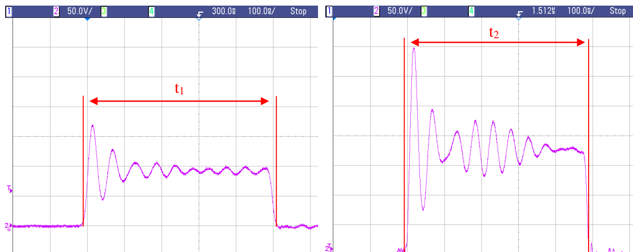
Obr. 58 Odečtení různé délky napětového pulsu vlivem rozptylové indukčnosti
