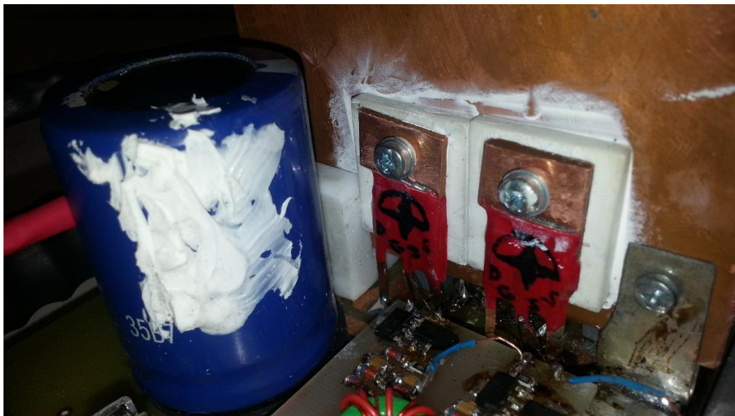
Obr. 42 Detail řešení „externích“ pouzder tranzistorů
