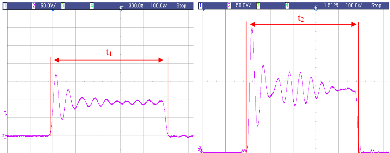
Obr. 58 Odečtení různé délky napětového pulsu vlivem rozptylové indukčnosti
