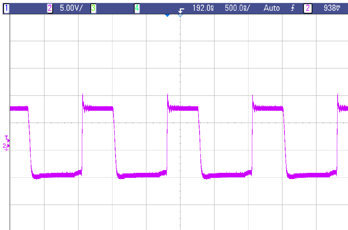
Obr. 9 Výstupní signál nezatíženého budiče při frekvenci 800kHz a střídě 0,35
