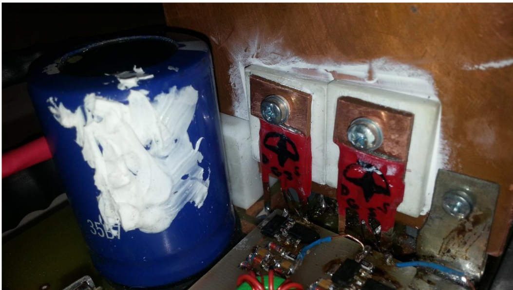
Obr. 42 Detail řešení „externích“ pouzder tranzistorů
