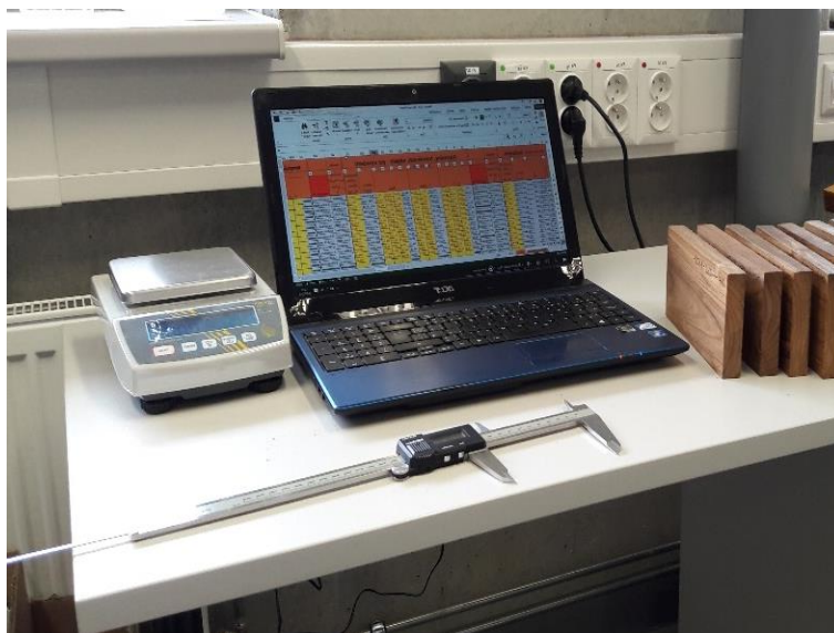
Obr. 21. Příprava a přeměrování vzorků ve školní laboratoři České zemědělské univerzity v Praze (dub letní teplota termické modifikace 180 °C)
