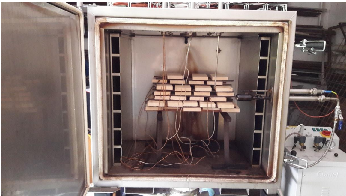
Obr. 23. Naplněná termo komora zkušebními vzorky smrku určenými k termické modifikaci
