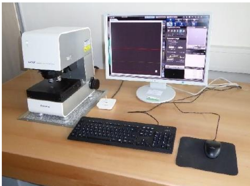
Obr. 33. Používaný přístroj pro bezkontaktní (laserovou) metodu měření LEXT 3D measuring laser microscope OLS4100 (Olympus)
