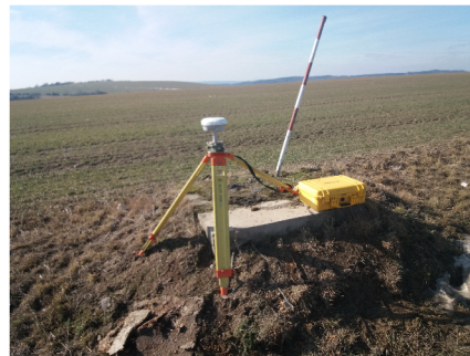
Obr. 10: Trimble M3 na bodě 4103 Obr. 11: Referenční stanice Trimble R4 na bodě 4104
