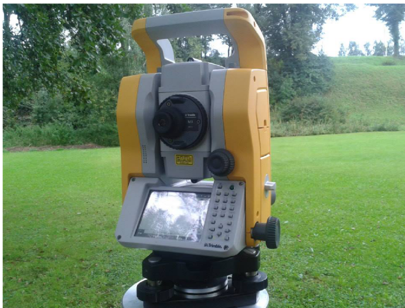
Obr. 6: Ukázka totální stanice Trimble M3
