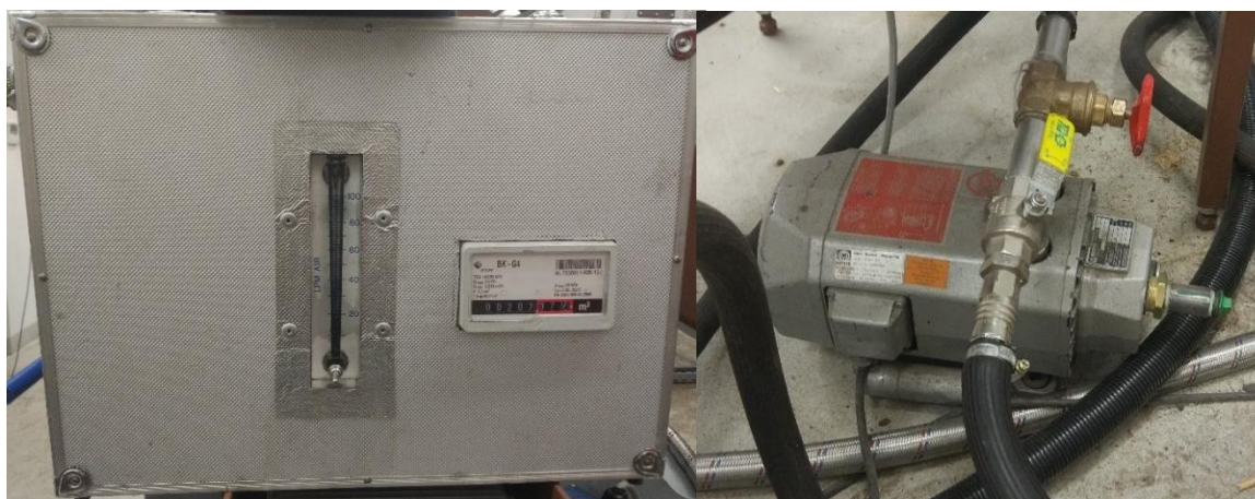
Obr. 3-4 Kufřík obsahující průtokoměr a plynoměr (vlevo), vývěva (vpravo).
