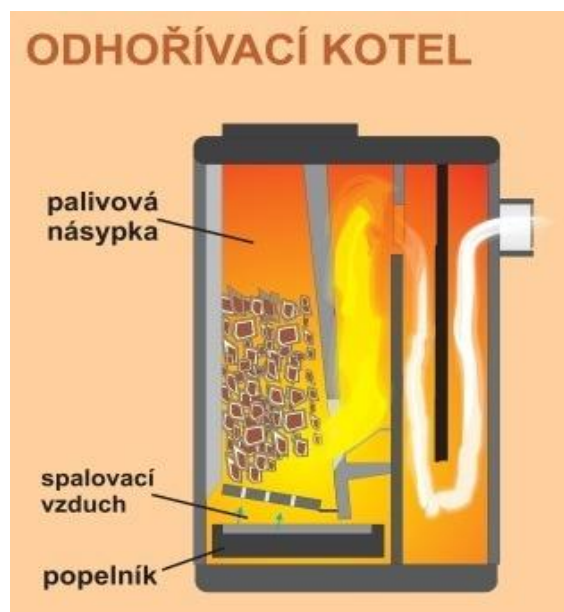
Obr. 2-2 Funkční schéma odhořivacího kotle [17].
