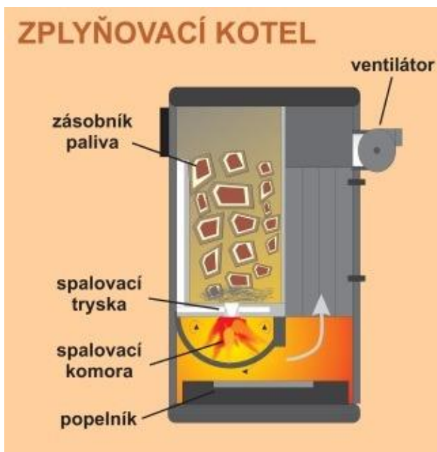
Obr. 2-3 Funkční schéma zplyňovacího kotle [17].
