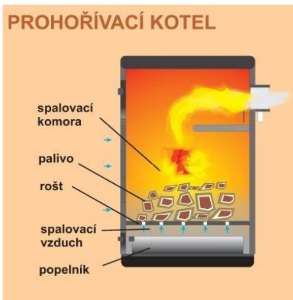
Obr. 2-1 Funkční schéma prohořivacího kotle [17].
