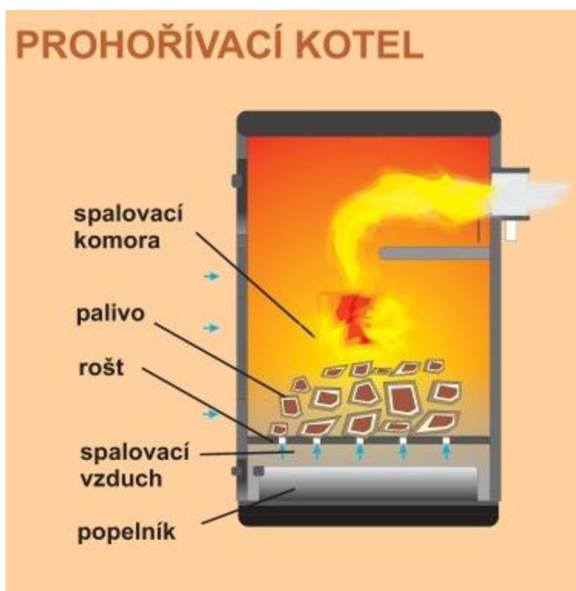
Obr. 2-1 Funkční schéma prohořivacího kotle [17].
