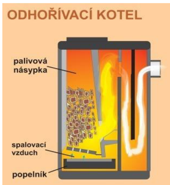
Obr. 2-2 Funkční schéma odhořivacího kotle [17].
