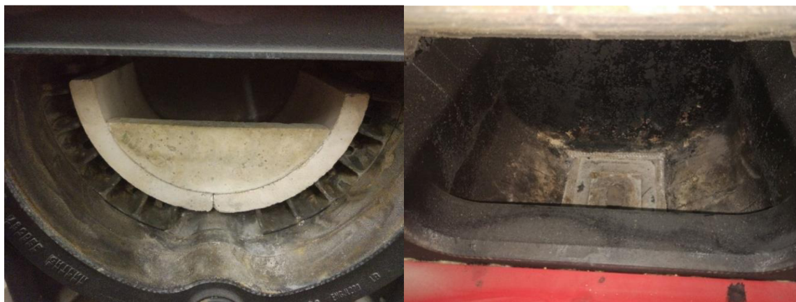
Obr. 3-2 Dolní spalovací komora (vlevo), násypka a zplyňovací keramická tryska (vpravo).
