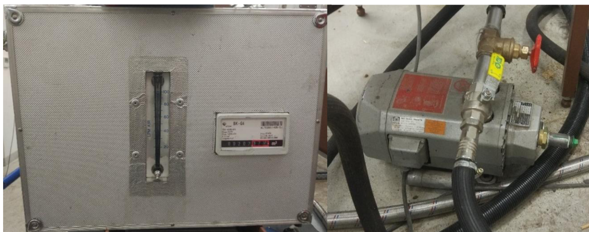
Obr. 3-4 Kufřík obsahující průtokoměr a plynoměr (vlevo), vývěva (vpravo).
