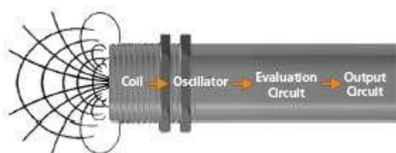
Obrázek 14 - Vnitřní řazení obvodů v indukčním snímači (20)
