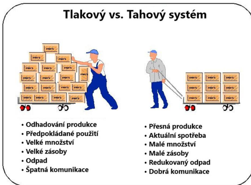
Obr. 2.5 Tlakový vs tahový systém [vlastní zpracování dle 16]
