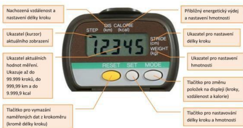
Obrázek 9: Pedometr Yamax Digiwalker SW-700 s popisem ovládacích prvků (Upol, on-line, 2016)
