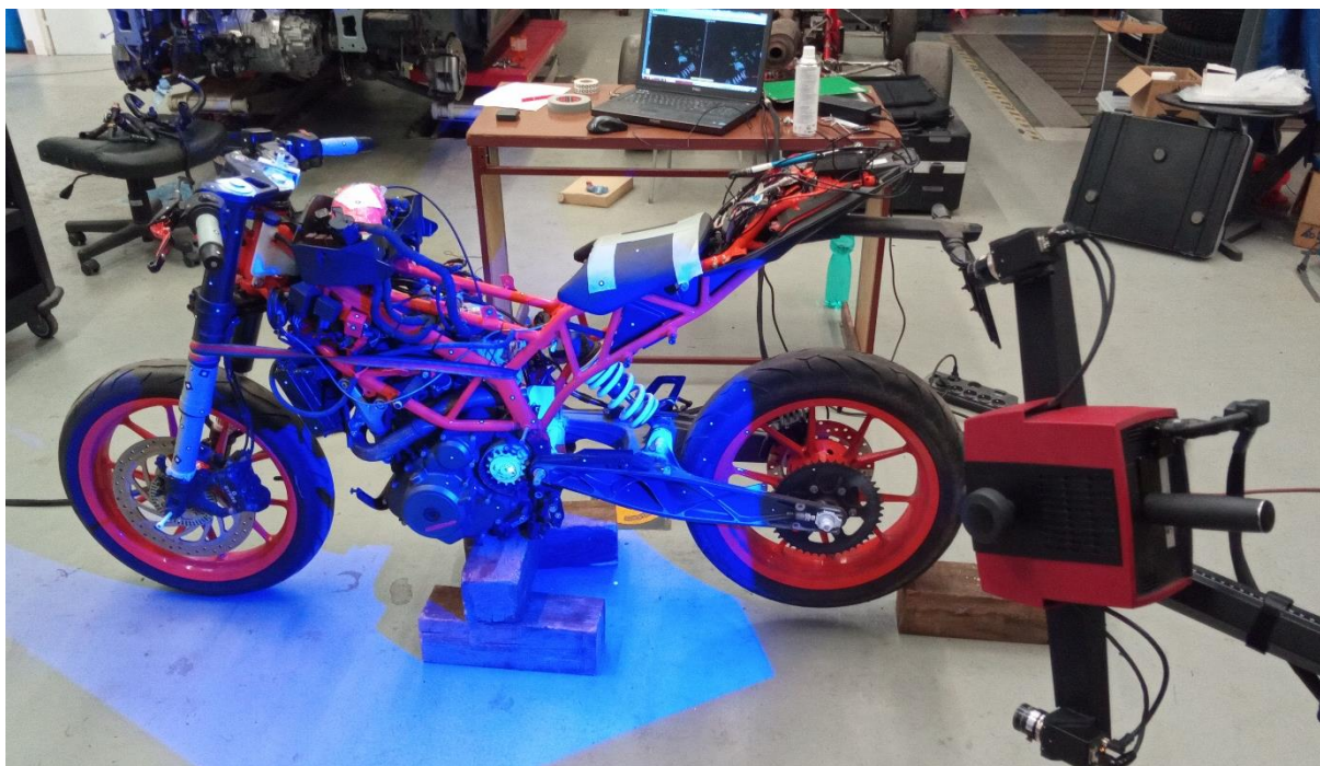
Obr. 2.2 KTM RC 390, 3D skenování, pohled 1
