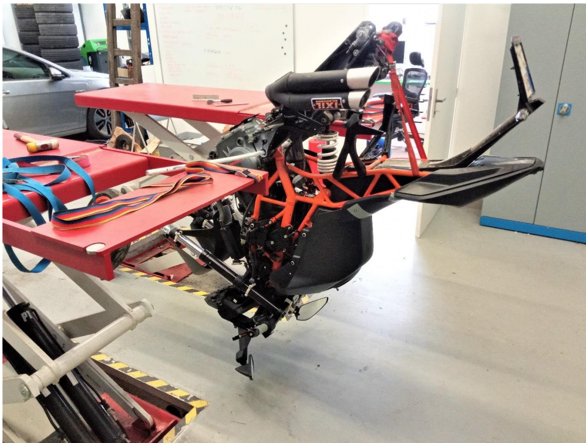
Obr. 2.16 Měření těžiště, zavěšení za osu kyvné vidlice
