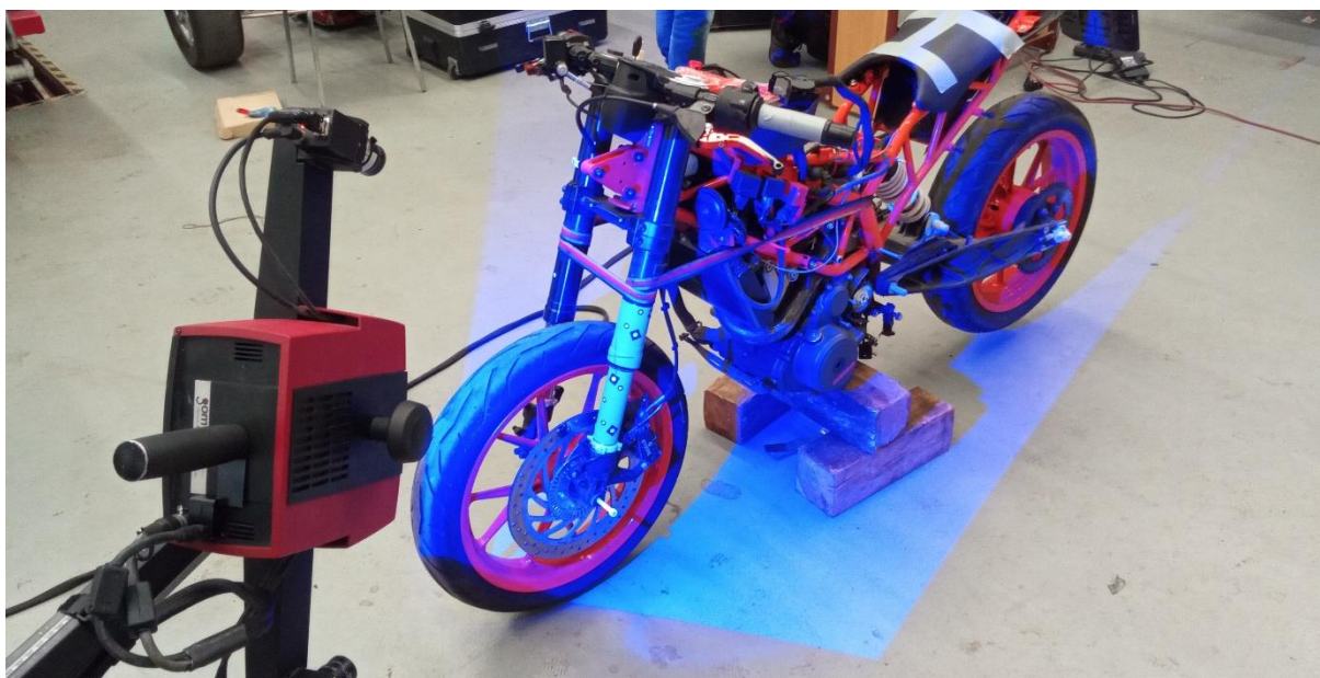
Obr. 2.3 KTM RC 390, 3D skenování, pohled 2
