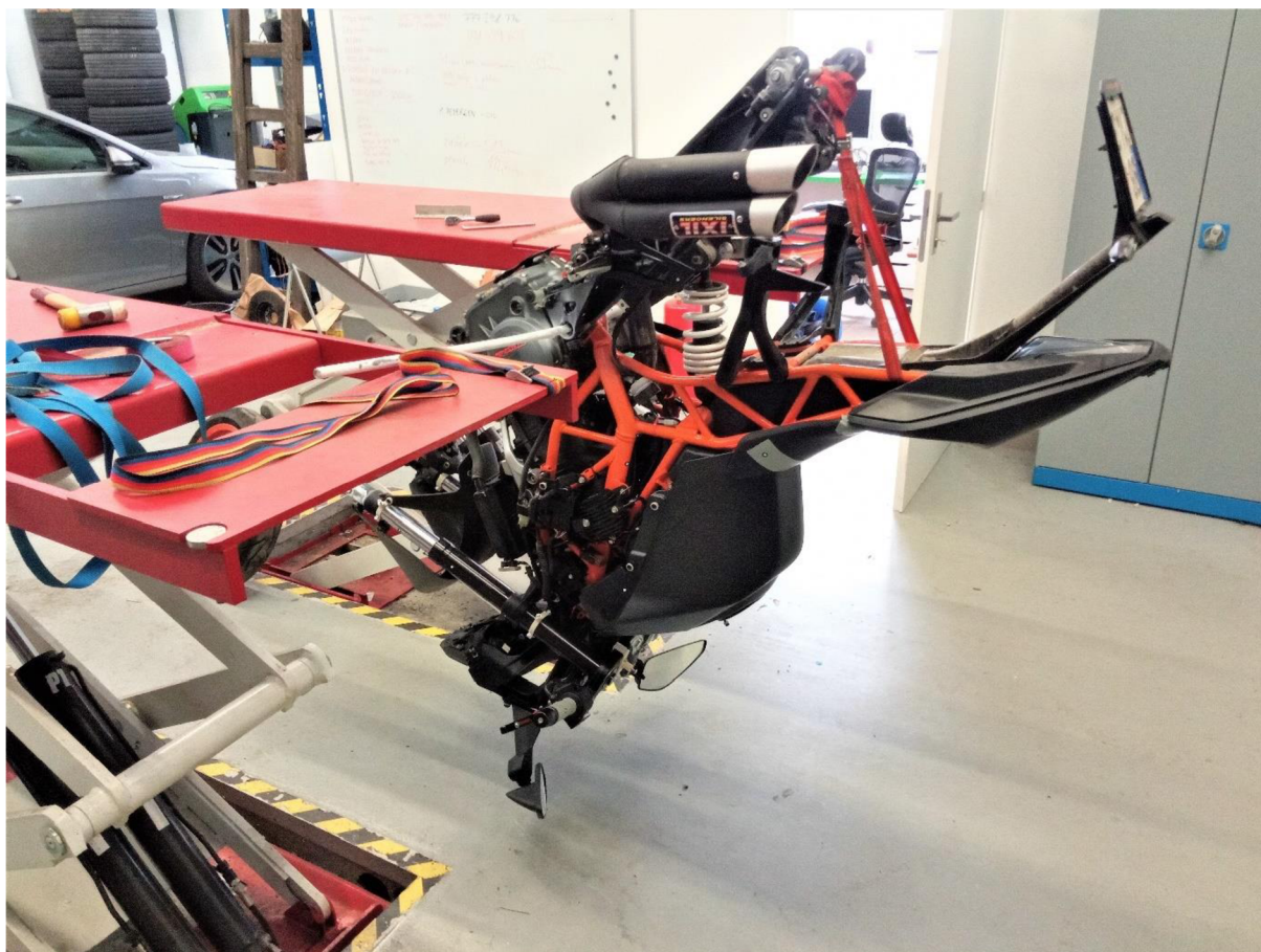
Obr. 2.16 Měření těžiště, zavěšení za osu kyvné vidlice
