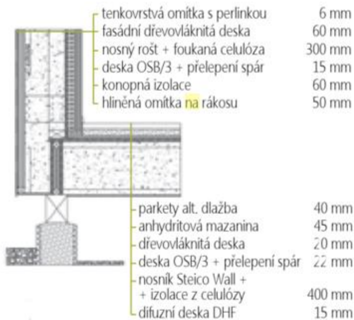
Obr 26 založení na základových patkách (Zdroj: (Hudec, 2013 str. 67)
