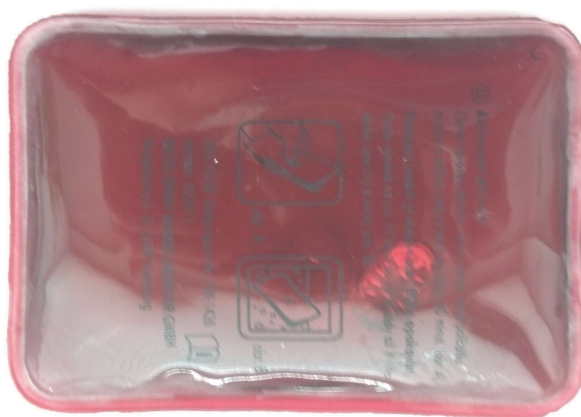
Obr. 4.5: Zahřívací vzorek v kapalné fázi
