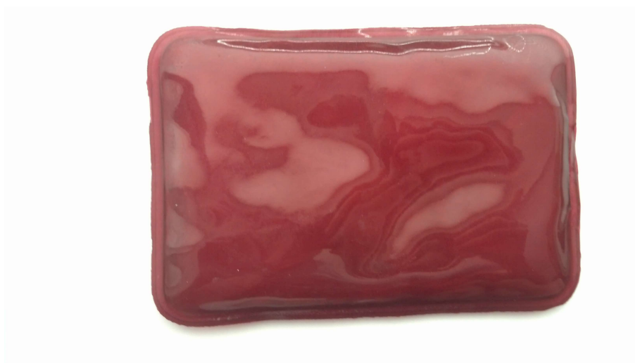
Obr. 4.7: Zahřívací vzorek v pevné fázi
