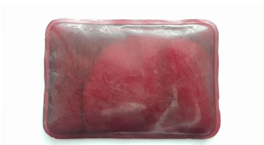
Obr. 4.6: Zahřívací vzorek v přechodu na pevnou fázi
