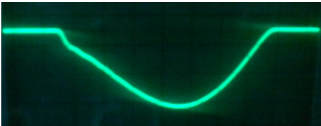
Obr. 5.2: Přechodové zkreslení koncového tranzistoru
